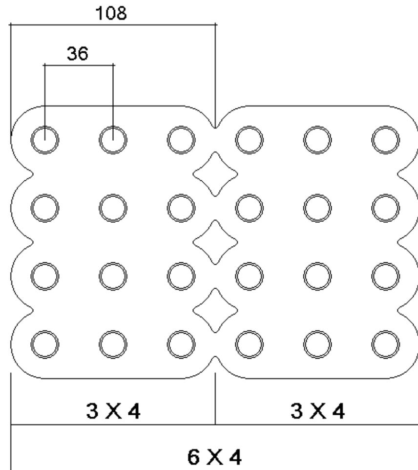
Con questo standard di alette possiamo realizzare batterie da n°2 a n°24 tubi e da n°2 a n° 10 ranghi per pacchi alettati con lunghezza da 20 a 150 cm.
