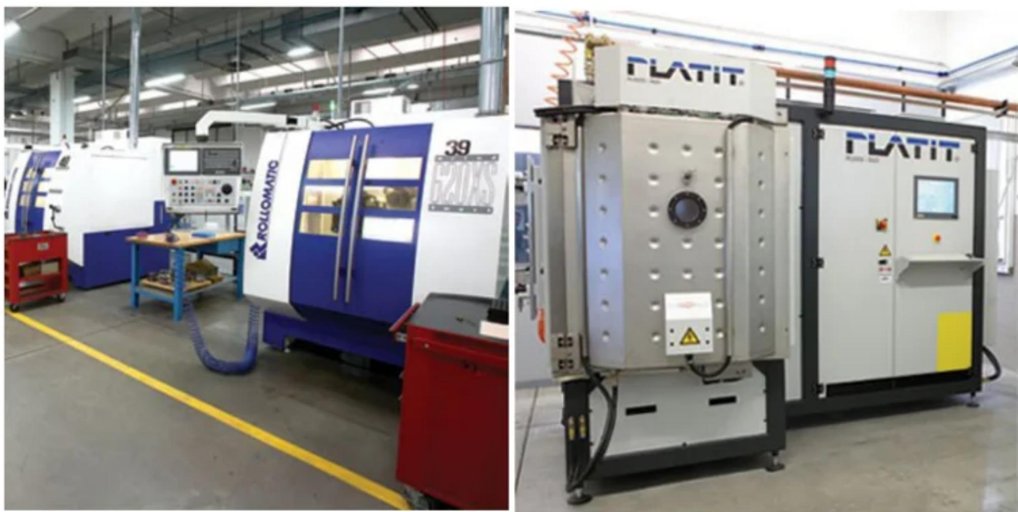
In collaborazione con il centro **Coating TUNIT Omicron** di Corropoli, certificato e specializzato nei rivestimenti con il metodo **PLATIT**, per utensili in HM e HSS, Stampi e Componenti per l'industria automotive, offriamo un valido servizio di affilatura e rivestimenti.
