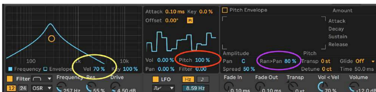
4.13 A sinistra particolare del Drum Rack utilizzato per far suonare la pianta. In blu le impostazioni per il filtraggio delle note midi in ingresso, in rosso gli 80 pad utilizzati. Sotto, dettaglio di un singolo pad in cui è presente in giallo la modulazione tramite velocity in ingresso del cutoff del filtro passabanda, in rosso il cambio pitch tramite LFO e in viola la spazializzazione stereofonica randomica
