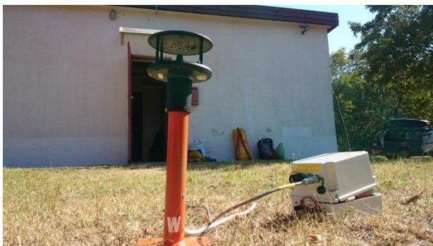
Anemometro ad ultrasuoni in collaudo presso la Staz. Scientifica
