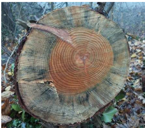
Foto 1.4: Tronco di pino con l'alburno attaccato dal fungo dell'azzurramento. (Foto Niccolò Mingione)
