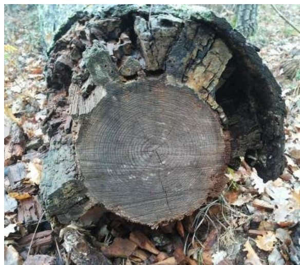
Foto 1.5: Tronco di pino con l'alburno attaccato dal fungo della carie. (Foto Niccolò Mingione)
