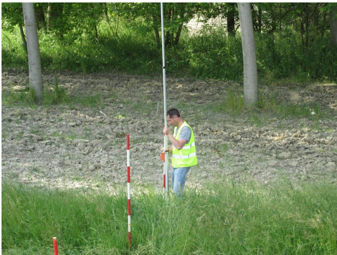
Foto 3.3 Una delle stadiie graduate e allungabili utilizzate.
