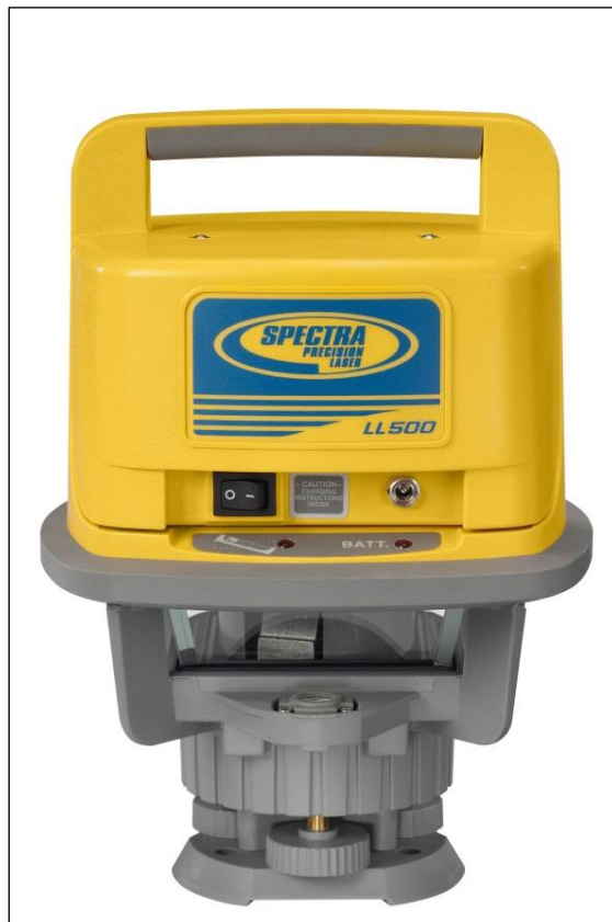
Foto 3.2 Modello del livello laser utilizzato.
