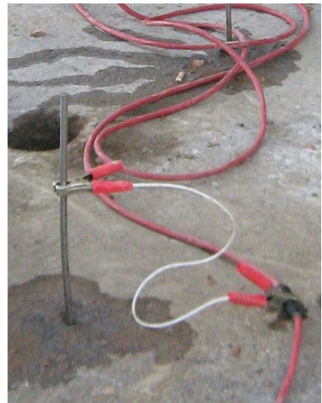
Figura 3: Elettrodi utilizzati per l'acquisizione geoelettrica
