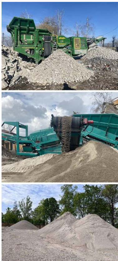
Fig. 4. Impianto pilota per il riciclo delle macerie a Hostomel, Kiev, Ucraina.
