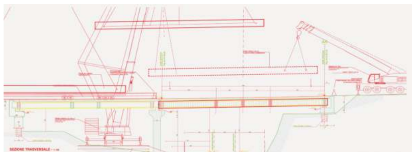
In alto e nella pagina seguente: Roma, nuovi sovrappassi ferroviari in località Fidenza. Sezione del progetto di varo e viste delle aree di intervento durante i lavori. Disegno e foto di A. Lacerenza
