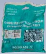
I CHIODI PER POLYTEGOLA N sono chiodi roofing a testa larga, in acciaio zincato da 20 e da 25 mm e sono necessari per il fissaggio meccanico delle tegole bituminose.
