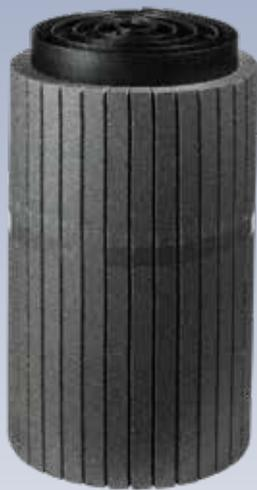
POLYSOL IPO G è un sistema termoisolante ottenuto dall'accoppiamento a caldo tra una membrana bitume polimero elastoplastomerica e polistirene espanso sinterizzato con GRAFITE con conduttività termica  $\lambda_D = 0,030 \text{ W/mK}$ .
