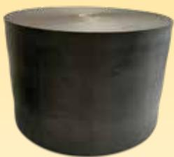
SONIC WALL è una fascia tagliamuro in polietilene ad elevata densità appositamente studiata per svolgere la funzione di elemento di desolidarizzazione di tutte le tramezzature interne ed esterne, al fine di limitare la trasmissione di rumori impattivi dalle pareti al solaio portante. Garantisce un'elevata elasticità permanente in grado di smorzare le vibrazioni pur mantenendo un'elevata resistenza alla deformazione, evitando la formazione di cavillature tra la parete ed il soffitto.
