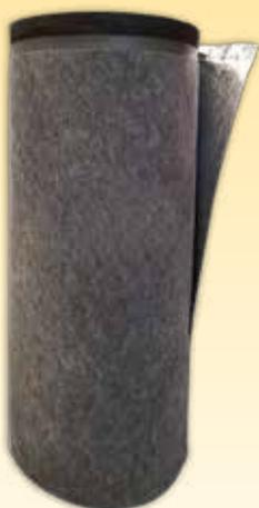
SONIC ROLL PLUS è un materassino acustico anticalpestio composto da polietilene espanso reticolato accoppiato sul lato inferiore a fibra di poliestere e sul lato superiore ad un film alluminato con funzione di barriera vapore e protezione meccanica. La specifica battentatura adesiva consente di evitare l'applicazione di nastro di sigillatura fra i teli. SONIC ROLL PLUS ha uno spessore nominale di 7 mm.
