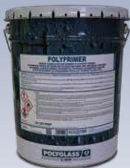
POLYPRIMER è un primer bituminoso a base di bitumi ossidati e solventi tecnici, viene utilizzato come promotore di adesione per bloccare la polverosità e la porosità delle superfici di calcestruzzo. Questo prodotto consente la veloce stesura e applicazione delle membrane bitume polimero, sia nelle applicazioni a caldo con fiamma che in quelle a freddo con collanti bituminosi o membrane autoadesive.
