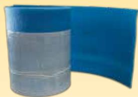
SONIC BAND è una fascia perimetrale adesiva in polietilene espanso a cellule chiuse da applicare alle pareti perimetrali e su tutti gli elementi che attraversano il massetto al fine di evitare la formazione di ponti acustici, predisposta con cordonatura "a L" per agevolare la posa in opera. L'adesivo removibile è pre-inciso in modo da realizzare la spellicolatura in due fasi distinte in maniera da facilitare l'esecuzione del dettaglio di posa.
