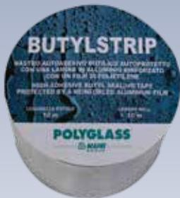
BUTYLSTRIP è un nastro autoadesivo butilico autoprotetto con una lamina in alluminio rinforzato e film di polietilene. La lamina in alluminio conferisce al prodotto resistenza all'invecchiamento, all'ossidazione ed all'aggressione degli agenti chimici ed atmosferici.
