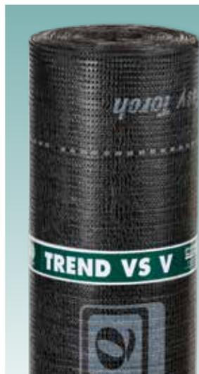
TREND VS V è una membrana PLASTOMERICA (BPP) impermeabile prefabbricata, in grado di offrire buone prestazioni. Costituita da compound a base di bitume distillato modificato con polimeri. TREND VS V è armata in velo vetro che conferisce una limitata resistenza al punzonamento e caratteristiche di buona stabilità dimensionale.
