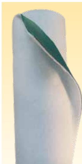
SONIC ROLL è un materassino acustico anticalpestio in materiale resiliente accoppiato sul lato inferiore a fibra di poliestere e sul lato superiore ad un geotessile con funzione di protezione meccanica anti-lacerazione.
