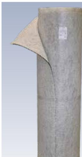
POLYSTUOIA 20 e POLYSTUOIA 20 L sono geo compositi costituiti da due geo tessuti filtranti in polipropilene da fiocco, stabilizzati ai raggi UV ed agglupati meccanicamente con interposta una struttura drenante tridimensionale costituita da monofilamenti in polipropilene.
