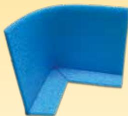
SONIC ROLL ANGOLI è un accessorio specifico per la realizzazione di “massetti galleggianti” secondo la UNI 11516:2013, in presenza di qualunque tipologia di solaio. Consente di garantire, con grande praticità ed assoluta semplicità, la continuità della Fascia Perimetrale SONIC BAND in corrispondenza di angoli interni ed esterni, presenti nelle murature all'interno di un edificio.
