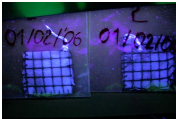
Fig. 8 – Fluocaptore positivo (sx) e negativo (dx) osservati alla lampada di Wood (foto R. Zorzin)
