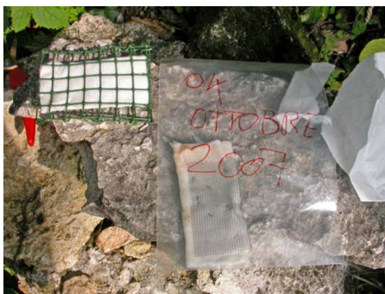
Fig. 40 – Sostituzione dei fluocaptori presso la Sorgente Vajo Stroo (4 ottobre 2007) – (foto R. Zorzin)
