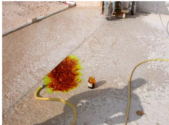
Fig. 10 – Test con fluoresceina realizzato durante le fasi di segazione di calcari lastrolari per verificare la corretta sigillatura delle fratture beanti al fine di evitare l’infiltrazione nel sottosuolo delle acque utilizzate (foto A. Zorzin)
