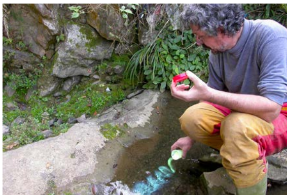
Fig. 5 – Cina: Progetto Guizhou 2003. Tracciamento con Tinopal spargendo manualmente e in piccole quantità la polvere del tracciante direttamente nel corso d'acqua (foto L. Latella)
