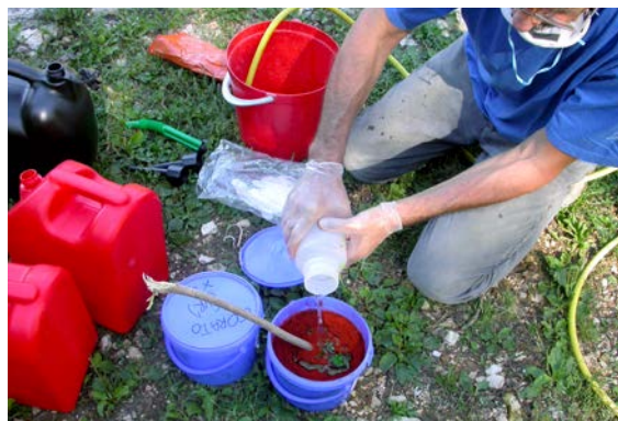
Fig. 6 – Preparazione della fluoresceina in varie concentrazioni da conservare in taniche non trasparenti per evitare/limitare il decadimento fotochimico (foto A. Zorzin)
