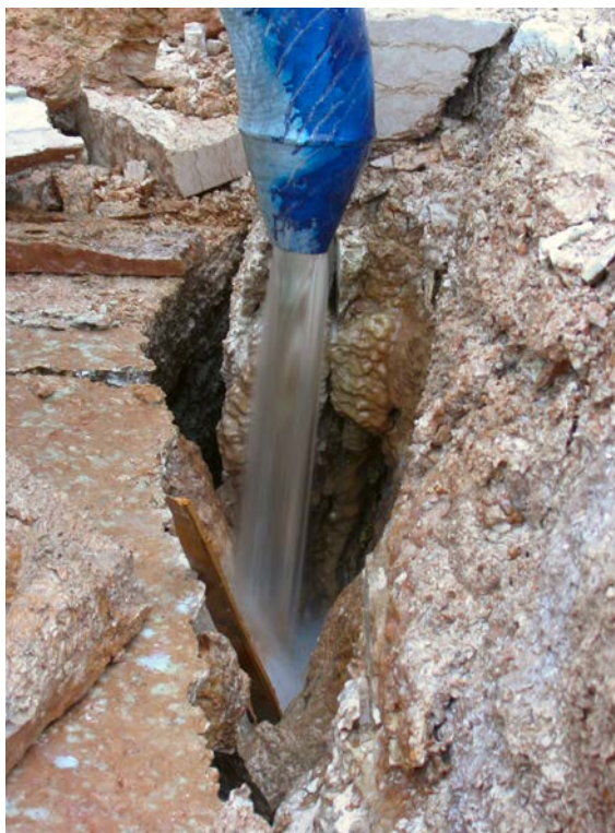
Fig. 18 – Il test con Tinopal eseguito il 25 gennaio 2006 e veicolato con circa 1.500 litri di acqua (foto R. Zorzin)
