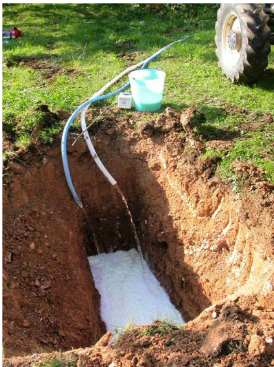
Fig. 38 – Test con Tinopal del 17 settembre 2007 (foto R. Zorzin)
