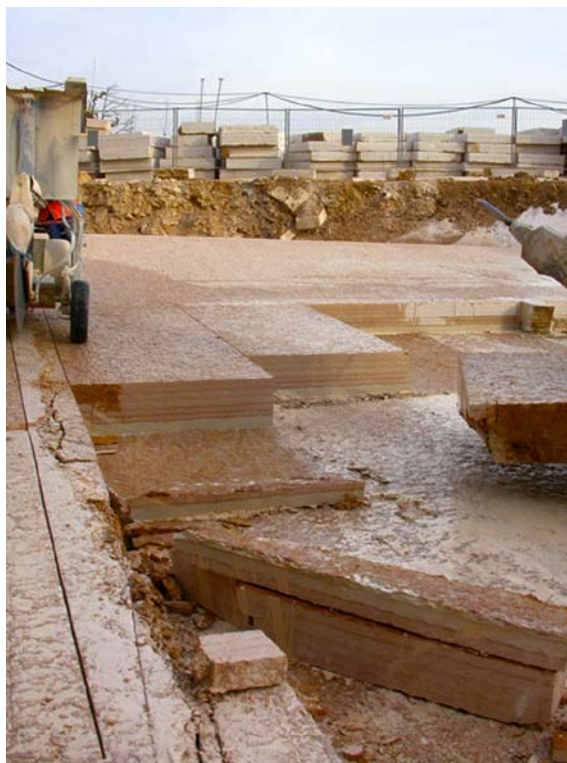
Fig. 17 – La frattura incarsita individuata il 25 gennaio 2006 durante la coltivazione della cava (foto R. Zorzin)
