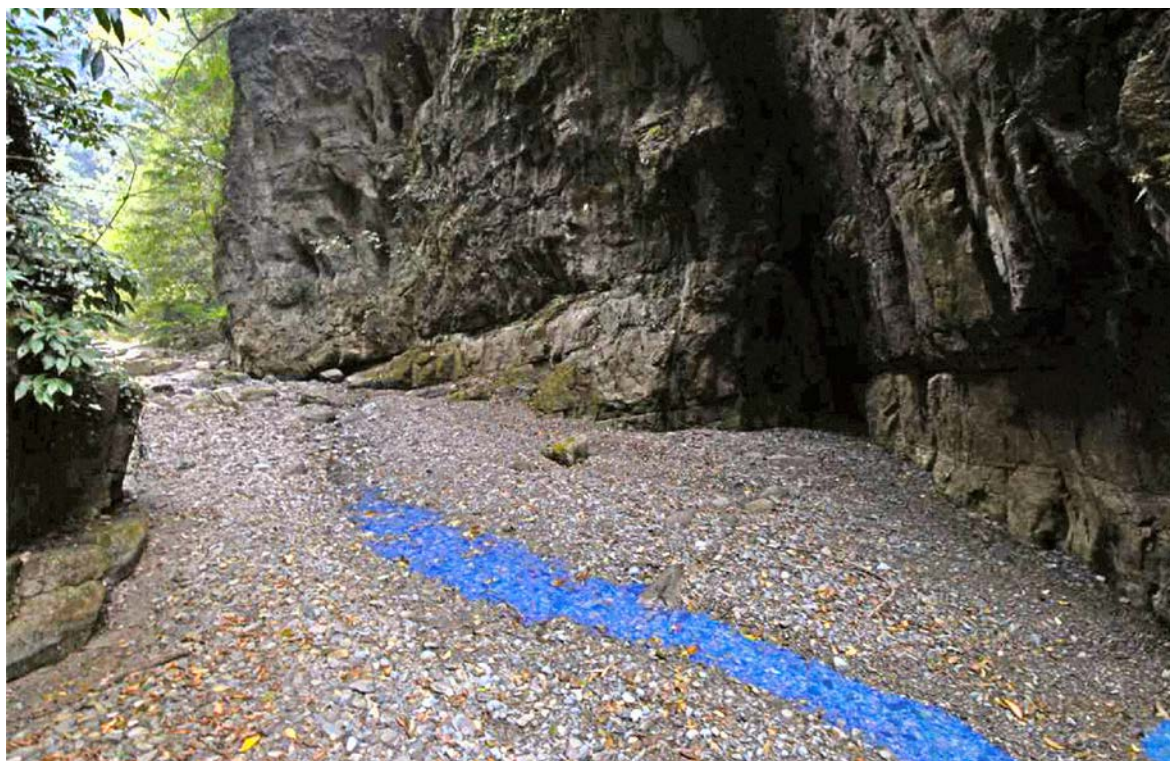
Fig. 9 – Tracciamento con Tinopal nelle alluvioni di Street River (foto A. Zorzin)
