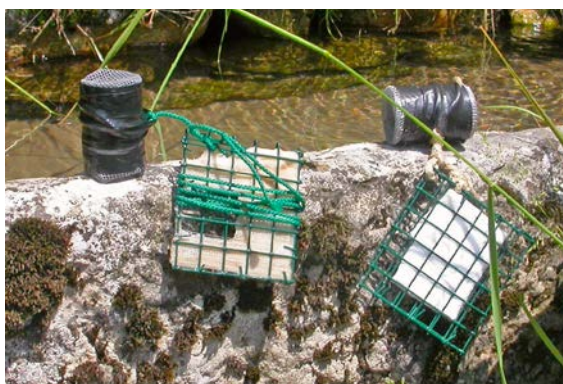
Fig. 7 – Fluocaptori auto-costruiti utilizzando tubi di plastica contenenti carbone attivo e reticelle con inserite garze in cotone. A sinistra i fluocaptori appena recuperati dalla sorgente, a destra quelli ancora da utilizzare (foto R. Zorzin)
