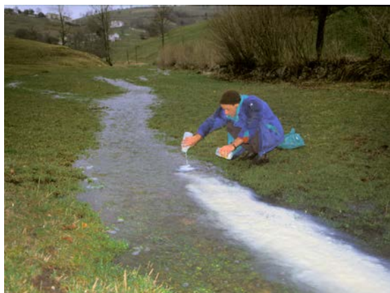
Fig. 43 – Tracciamento del corso d'acqua con Tinopal (21 marzo 1999) - (foto R. Zorzin)
