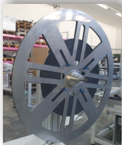
Bobina porta materiale regolabile ed a caricamento rapido.
