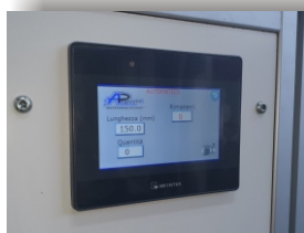
Quantità e misura impostabili da pannello operatore touch screen.
