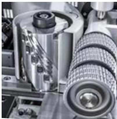
Le teste di piallatura a spirale sono dotate di lame metalliche resistenti all'usura. Gli utensili sono adatti alla sgrossatura o alla lavorazione del legno duro.
