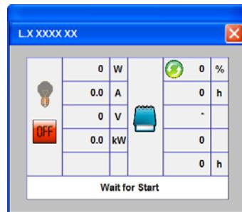
Controllo elettronico delle sue funzioni con lettura sul display delle fasi di avviamento in automatico, controllo automatico delle tensioni di lavoro, assorbimento, numero di ore lavorate, temperature riflettori, quantità di energia in emissione UV, check-control anomalie.
