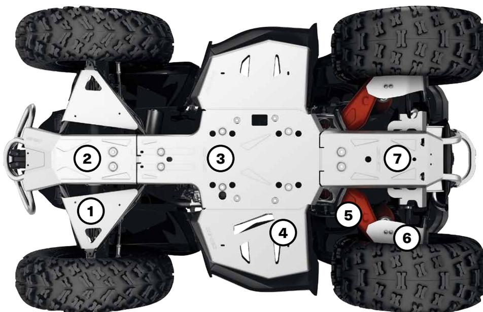
Per garantire la massima resistenza e robustezza, tutte queste piastre salvatelaio sono realizzate in alluminio 5052 H32 ad alta resistenza con spessore 4,5 mm.
