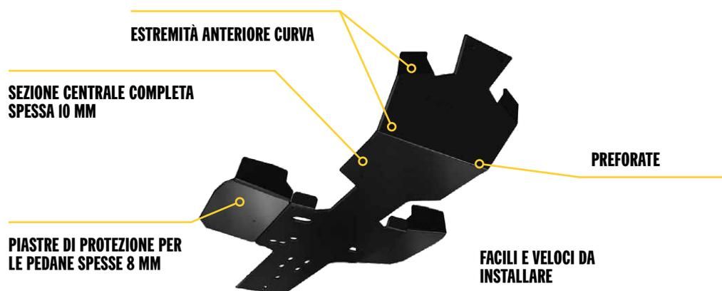
Le nostre piastre in plastica sono in grado di superare qualsiasi ostacolo, garantendo la necessaria protezione sui terreni più difficili. Realizzate in polietilene ad elevato peso molecolare (HMWPE) termoformato e resistente all'abrasione.
