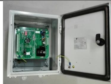
Le serie 555 e 556 sono amplificatori progettati per la sola diffusione acustica nei sistemi di diffusione sonora industriale VAL-TRONICS. Vengono utilizzati, in aggiunta ai posti di chiamata, per aumentare il livello di emissione sonora in ambienti industriali con elevato rumore di fondo e con presenza di atmosfere corrosive.
