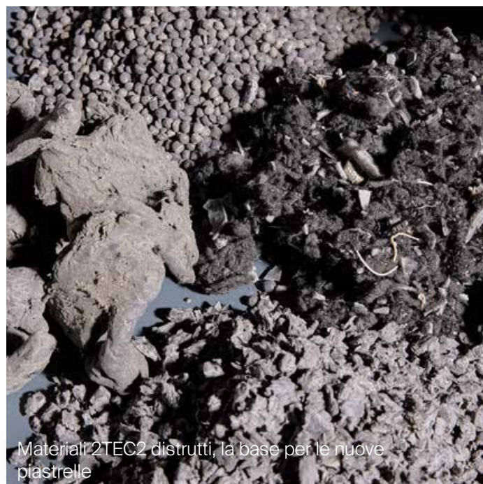
Rifiuti 2TEC2 distrutti e trasformati in nuove materie prime
