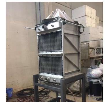
FUMI-ARIA scambio a flussi incrociati (se in alluminio max 200°C)
