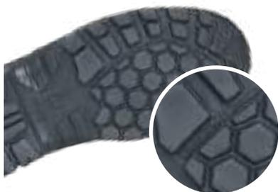
Gomma studiata per mantenere una buona flessione e comfort anche a basse temperature. I battistrada con tecnologia ICE GRIP sono realizzati disperdendo delle fibre all'interno della matrice in gomma con lo scopo di drenare ed assorbire i liquidi presenti sulle superfici gelate riducendo sensibilmente l'effetto acquaplaning tra suola e ghiaccio: la resistenza allo scivolamento rimane inalterata.
