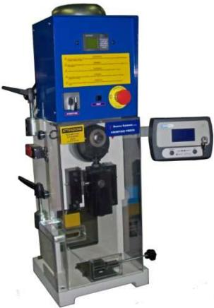
La pressa Gamma T-25 è una macchina progettata per l'aggraffatura di cavi con sezione fino a 10 mm<sup>2</sup>.
