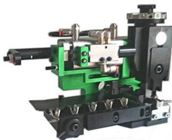
Per la lavorazione di terminali di grandi dimensioni, la Nuova Gamma propone applicatori ad alimentazione pneumatica dotati di utensili maggiorati.
