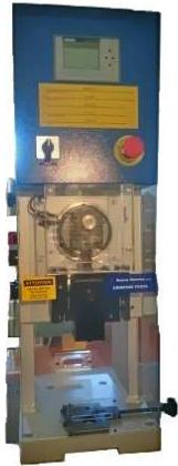
La presa Gamma T-50 è una macchina progettata per l'aggraffatura di cavi con sezione fino a  $25\text{ mm}^2$ .
