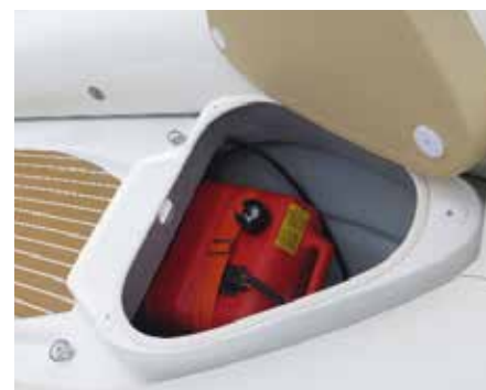
EASY 370 / 320: serbatoio a prua sotto il sedile e pavimento in teak di serie standard fuel tank under the bow seat and teak covered deck.
