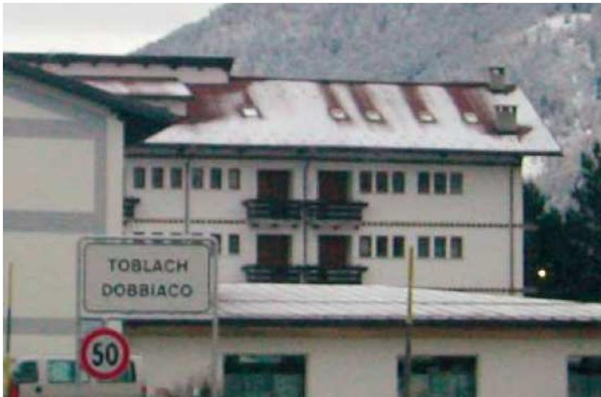
**Neve sciolta sopra le finestre del tetto per la permeabilità all'aria ! (uscita di calore)**
