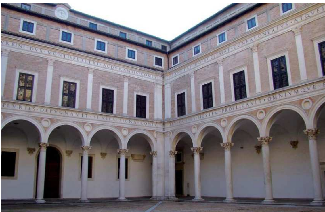
Figg. 24, 25. - Urbino. Palazzo Ducale. Due interventi attribuibili a Francesco di Giorgio: l'impostazione dell'ingresso in asse al cortile e la sistemazione del cortile principale con in evidenza la griglia architettonica compositiva e la soluzione angolare adottata.
