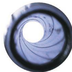
Fig. 33 Rigatura elicoidale della canna
