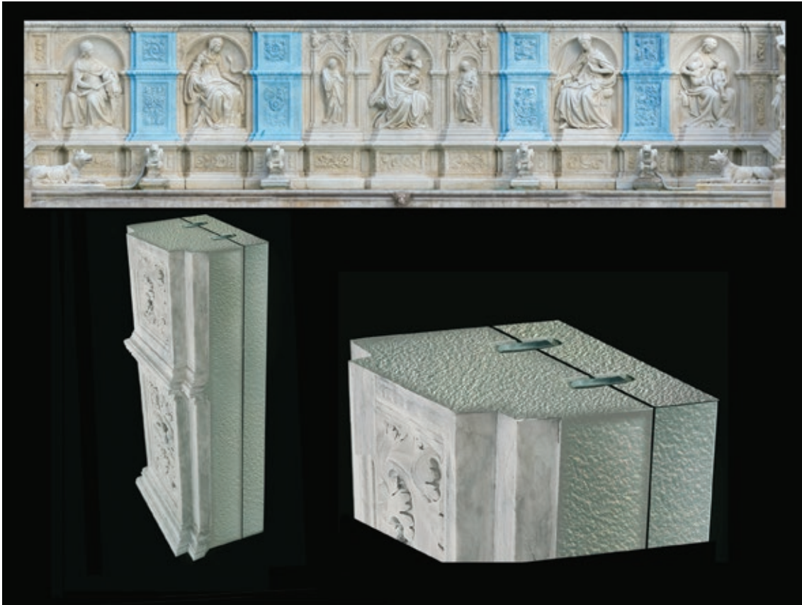
4. Presenza di due staffe in bronzo fissate con piombo per contenere i due blocchi di marmo che costituiscono il pilastro.
