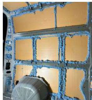
Strukturfüllung mit **aufgesprühtem Isoliermaterial** zwischen den Blechverstärkungen, um **Wärmebrücken zu eliminieren.**
