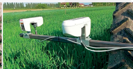
con sensori ottici ( GreenSeeker® ) da installare su trattori agricole
