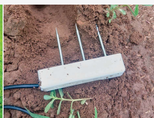
con sonde al suolo , per la misura in continuo del contenuto idrico, della temperatura e della conducibilità
