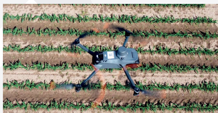
con droni equipaggiati con camera multispettrale e RGB
