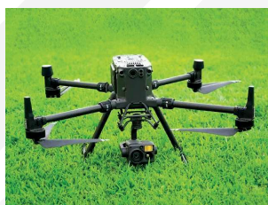
con drone dotato di camera termica
