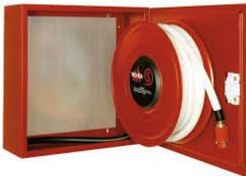
Il **naspo** è un'apparecchiatura antincendio permanentemente collegata ad una rete di alimentazione idrica, costituita da una bobina mobile su cui è avvolta una tubazione semirigida collegata ad un'estremità con una lancia erogatrice. La tubazione semirigida conserva pressoché intatta la sua forma anche quando non in pressione e la sua lunghezza massima è di 30 metri.
