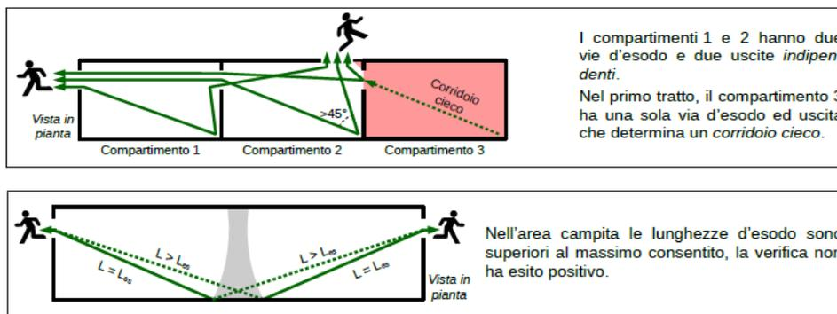
La larghezza delle vie di esodo orizzontali e verticali si determina in base:
