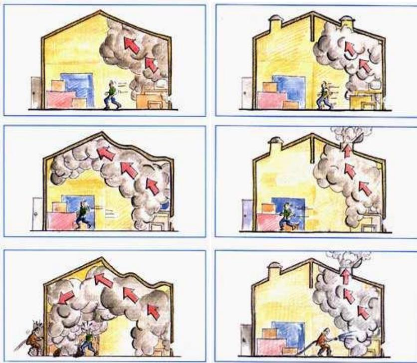
**b) Aperture di smaltimento di fumo e calore di emergenza**
