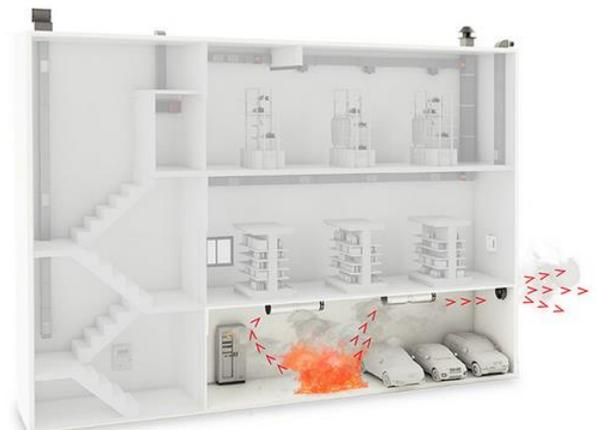
d) Sistemi di evacuazione del fumo e del calore (SEFC)
