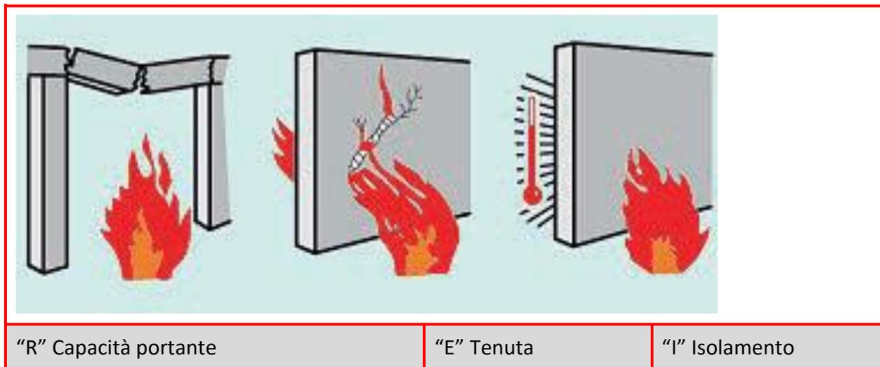
Dunque elementi portanti, quali ad esempio pilastri, potranno al più possedere requisiti di Capacità portante (R).
