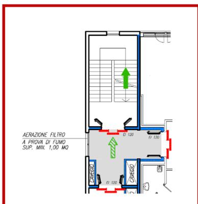
I percorsi d'esodo a prova di fumo (es. corridoi, scale, rampe, atri, ...) devono essere inseriti in vani a prova di fumo ad essi dedicati.
