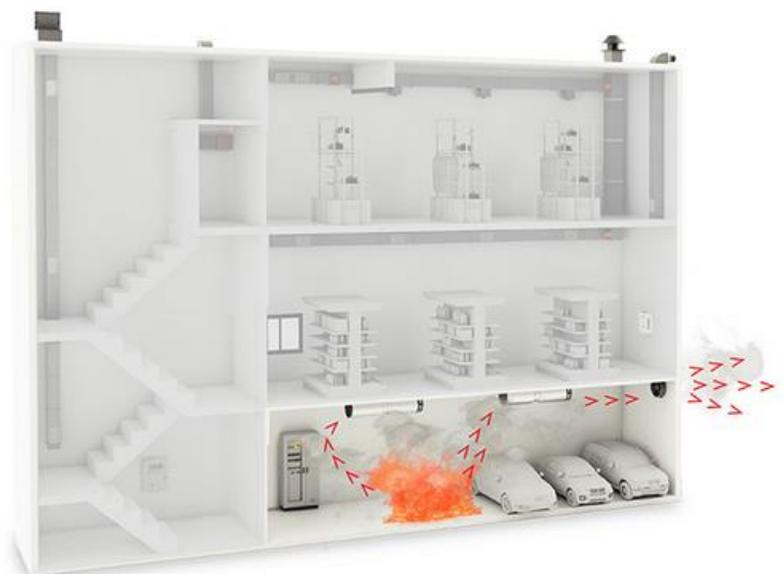
d) Sistemi di evacuazione del fumo e del calore (SEFC)
