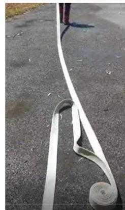
c) Ad avvenuta completa estensione della tubazione, girandosi indietro, si accerta che la condotta non abbia spire tali da determinarne delle strozzature (se del caso ruota la tubazione) e tornando verso la cassetta idranti, aziona la valvola per mettere in pressione la tubazione.
