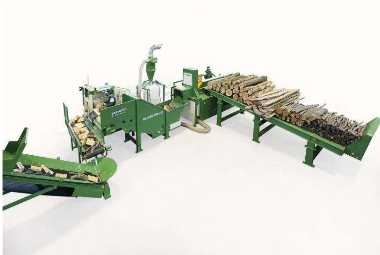
Fig. 10 Macchina combinata per la produzione di legna da ardere fissa
