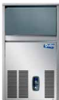
Q7601 Produttore di ghiaccio sist. a spruzzo - kg 36/24h - capac. serbat. Kg. 11,5 - cub. pieno
