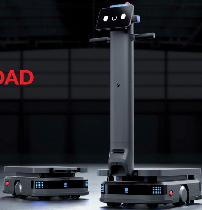
**PUDU T600** è un robot industriale progettato per la movimentazione efficiente di carichi pesanti in ambienti produttivi e logistici. Il telaio mobile robusto garantisce stabilità e sicurezza anche nelle applicazioni più impegnative. Touchscreen integrato, comandi rapidi e assistenza alla spinta permettono un utilizzo immediato senza sistemi di controllo esterni, riducendo i tempi di formazione e aumentando la produttività.
