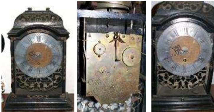
8 Orologio Bracket da tavolo. Orologiaio Friedrich Huguenin a la Chaux de Fonds, documentato nel 1778. Manifattura Svizzera del XVIII secolo. Movimento a gran sonnerie con ripetizione a cordicella e sveglia. Quadrante in metallo argentato.
