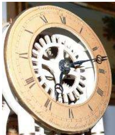
B Orologio da mensola scheletrico. Sul quadrante “Cartonage invariabile” e “a Paris chez Pacini...”. In legno e cartone. Carica dissimulata nel basamento, scappamento ad ancora inversa, pendolo in cartone indeformabile, sotto campana di vetro. Raro esempio di questa tipologia. Parigi circa 1825. Misure cm h. 36, cm. campana 45.
