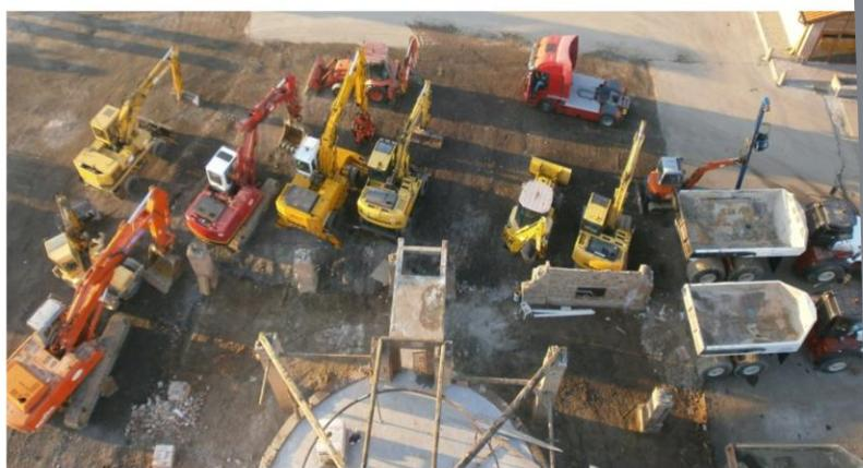
Il parco mezzi per il movimento terra comprende autocarri, autoarticolati, dumper, rulli compattatori, escavatori, mini escavatori, pale cingolate, pale gommate, mini pale e qualsiasi altro mezzo da utilizzare a seconda dello spazio disponibile sulla zona d'intervento, recando il minor intralcio possibile alla viabilità durante le lavorazioni e che permettono di gestire autonomamente l'esecuzione dei lavori presi in consegna.
