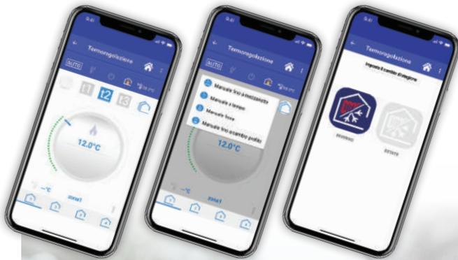
La gestione del confort termico è gestibile tramite una modalità di funzionamento ampiamente configurabile. L'utente può impostare i cambi di temperatura e i profili di funzionamento per ogni singola zona da **C.DOM** o da smartphone/tablet.
