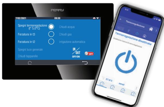
La funzione IN/OUT permette all'utente di impostare in maniera rapida l'uscita di casa.
