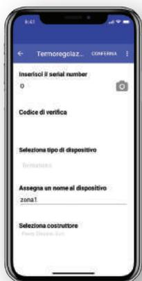
Tramite l'app, disponibile per dispositivi iOS e Android, è possibile inserire una nuova zona. È sufficiente fotografare il codice QR presente sul dispositivo da aggiungere (ad esempio un termometro o un termostato) e associarlo a una zona.
