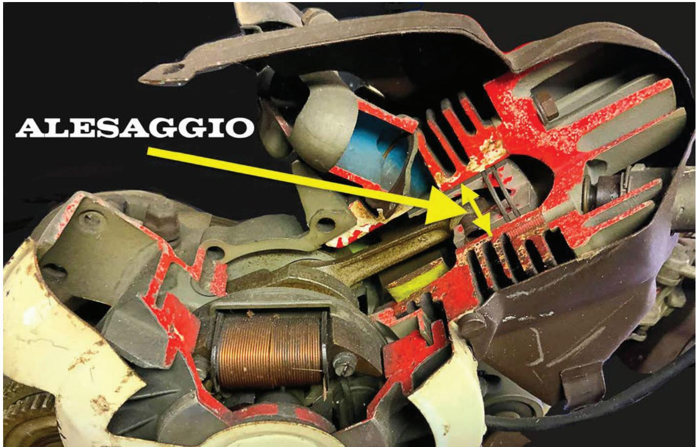
di cilindro: se è in lega di allumino ovviamente il RC può salire un po' a parità di altre condizioni.
