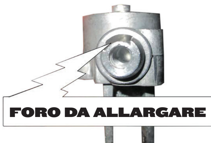
Dove intervenire Ecco il foro d'ingresso da allargare.
