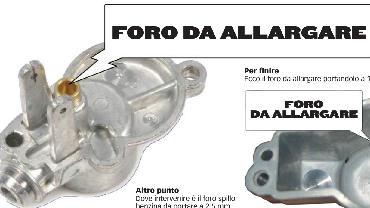
Dove intervenire Ecco il foro d'ingresso da allargare.
