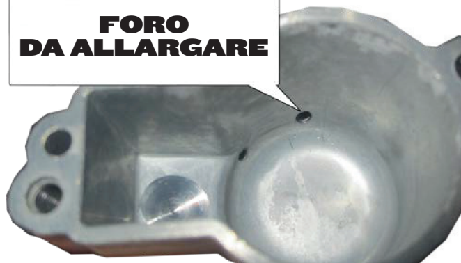
Altro punto Dove intervenire è il foro spillo benzina da portare a 2,5 mm.
