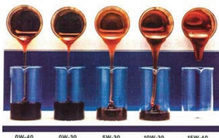
La viscosità cinematica è il rapporto tra la viscosità dinamica di un fluido e la sua densità, la viscosità dinamica di un fluido è una misura della sua resistenza a fluire quando è applicato uno sforzo tangenziale. Spesso viene anche chiamata diffusività cinematica, essa è una misura della resistenza a scorrere di una corrente fluida sotto l'influenza della gravità. Tale caratteristica dipende sia dalla viscosità dinamica sia dal peso specifico del fluido.
