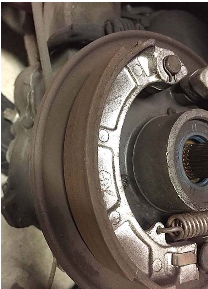
Punti deboli - I freni a tamburo soffrono l'acqua e il surriscaldamento.
