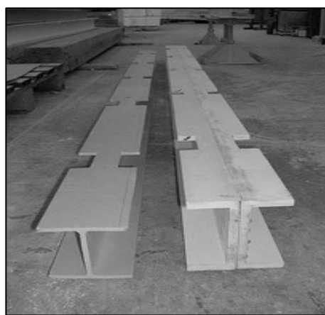
Figura 3. a) I profilati pultrusi con gli intagli praticati su una delle ali. b) Travi rinforzate con i profilati pultrusi intagliati per accogliere l'orditura secondaria di un solaio ligneo.
