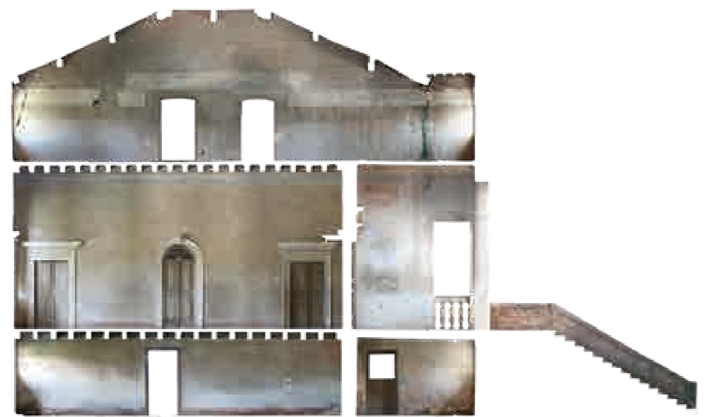
40 Sezione lungo l'asse nord-sud, verso est di Villa Forni Cerato, tratta dal rilievo fotogrammetrico eseguito prima del restauro nel 2018 dal Politecnico di Milano 40 Section along the north-south axis, east face of Villa Forni Cerato, taken from the photogrammetric relief created before the restoration in 2018 by the Politecnico di Milano
