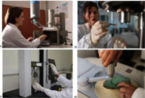
Foto 2 – Caratterizzazione delle pelli: a) Analisi mediante Microscopio Elettronico a Scansione (SEM) (foto di F. Paradiso); b) Analisi Termogravimetrica (TGA) (foto di F. Paradiso); c) prove di trazione (foto di F. Paradiso); d) analisi spettroscopica IR (FT-IR) (foto E. Bramanti)
