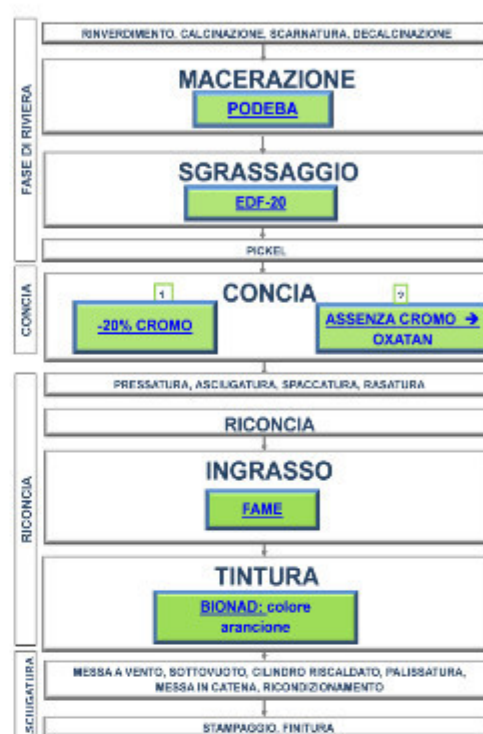
Figura 2 – Schema delle principali fasi di concia: in evidenza le fasi di intervento del progetto e i rispettivi prodotti innovativi utilizzati (schema di A. Strafella)
