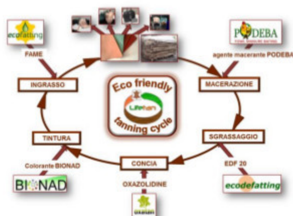
Figura 1 – Schema del ciclo di concia innovativo (schema di A. Strafella)
