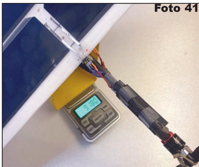
Foto 41 Il peso in ordine di volo. Si vede pure il piccolo motore e la batteria tampone che è infilata in un tubetto. Si vede pure la spinetta che collega le celle solari all'ESC
