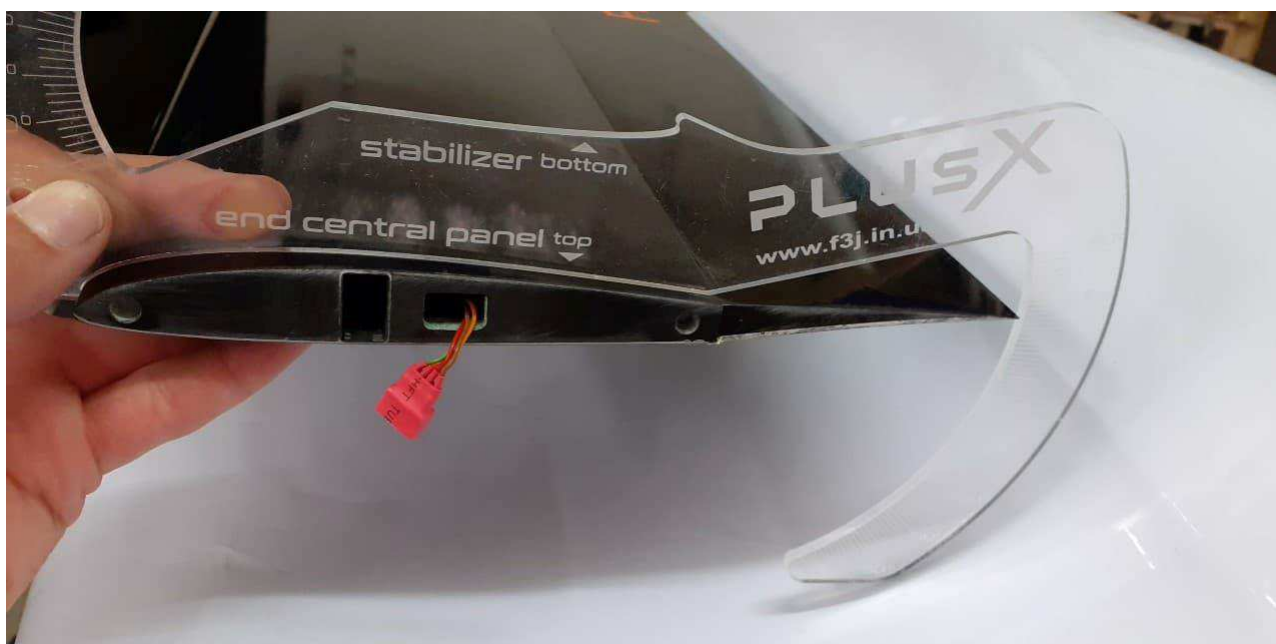
Esempio di strumento che consente la misurazione precisa della deflessione delle parti mobili per simmetrizzare le regolazioni.
