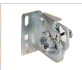
Paracadute molle (serie su tutti i portoni) Sistema di sicurezza che interviene bloccando la caduta del portone in caso di rottura dei cavetti di sollevamento.
