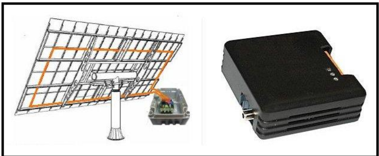
Il sistema di antifurto basato su un anello di fibra ottica.
